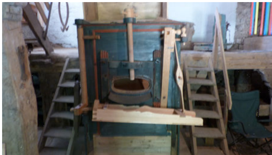
Der Mehl- oder Beutelkasten zur Trennung von groben und feinen Mahlgut.
