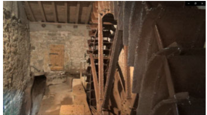
oben: Das Zuppinger-Wasserrad links: Beschriftung des Wasserrades
