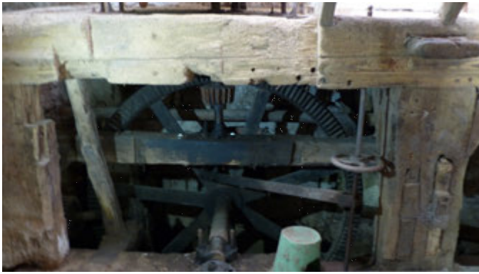
Das Kammrad, das von der mit dem Wasserrad verbundenen Welle den Läuferstein antrieb.
