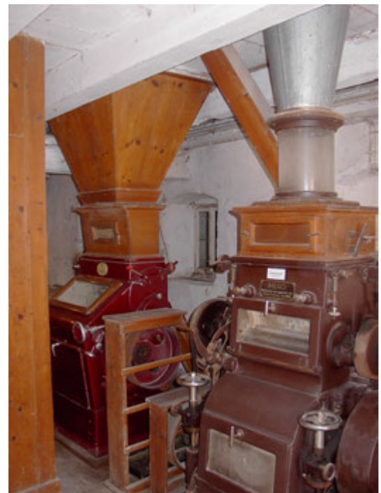
Walzenstühle ersetzen die Mühlsteine. Foto: Hm
